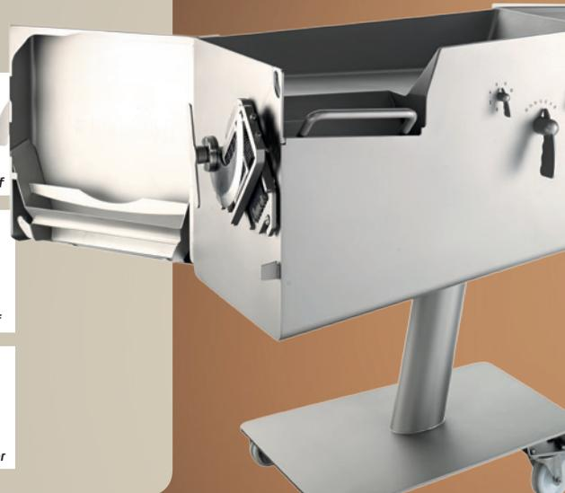
Würfel, Streifen oder Scheiben können in vielfältige Schnittgrößen geschnitten werden. Dabei muss immer berücksichtigt werden, dass Schneidgrößen von 5 mm<sup>3</sup> eine Stundenleistung von 150 kg bringen, dagegen Würfel mit einer Größe von 30 mm<sup>3</sup> bis zu 1500 kg erreichen.
